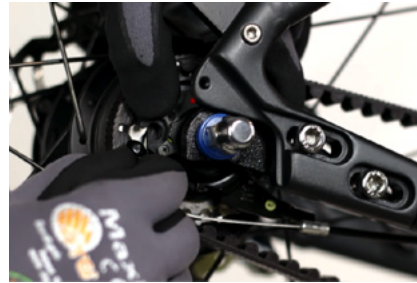
zu 3. Schaltzug vom Hinterrad lösen
