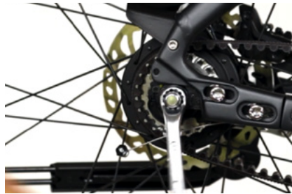
zu 4. Achsmuttern lösen
