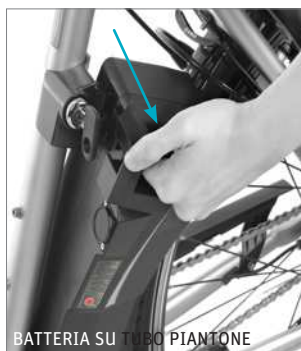
BATTERIA SU TUBO PIANTONE
