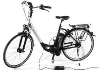
SITZROHRBATTERIE Aufladen der Batterie
