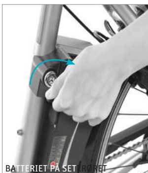
BATTERIET PÅ SETERØRET
