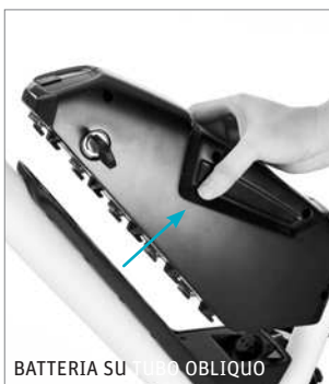
Rimozione della batteria
