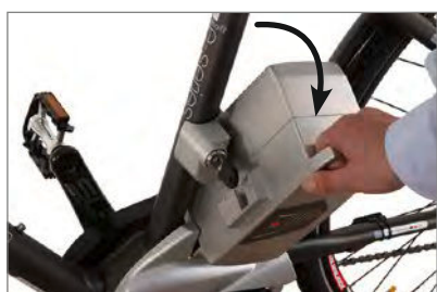
Basculer la batería para extraerla
