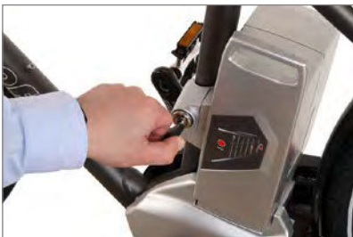
Entriegeln der Batterie
