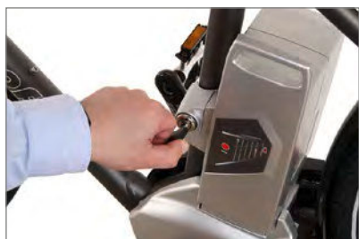
Sbloccare la batteria
