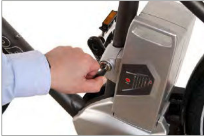
Entriegeln der Batterie
