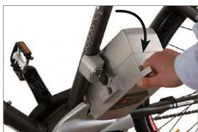
Sfilare la batteria inclinandola
