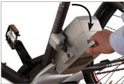
Bascular la batería para extraerla
