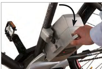
Basculer pour retirer la batterie
