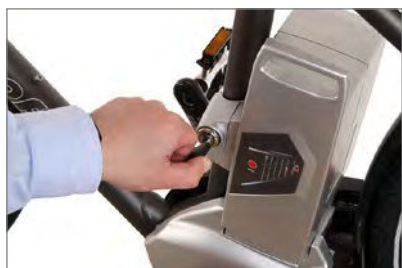
Desbloquear la batería
