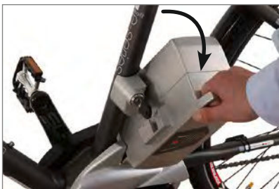
Sfilare la batteria inclinandola
