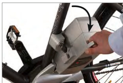
Basculer pour retirer la batterie
