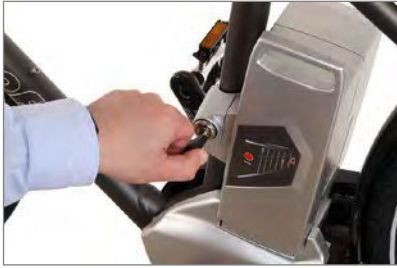
Desbloquear la batería
