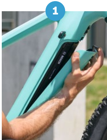
Öffnen der Rahmenabdeckung
