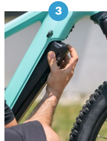
Akku durch Druck von oben aus der Rückhaltesicherung lösen – Akku fällt in die Hand
