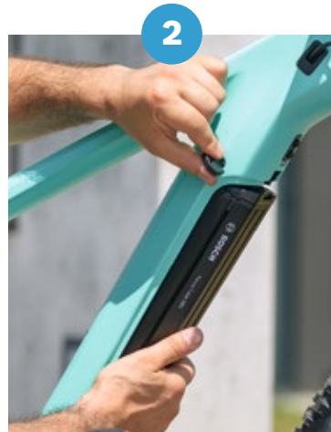
Durch die Entriegelung des Akkus per Schlüssel fällt der Akku in die Rückhaltesicherung
